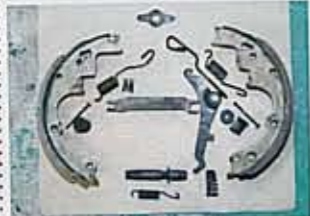
続いてドラム内にある細かいスプリングを新品に交換していく。
